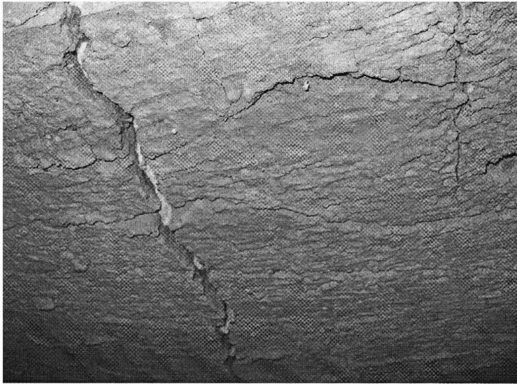
شكل رقم (١٤) : شروخ الانحناء بالبلاطات S2, S3 and S4.
