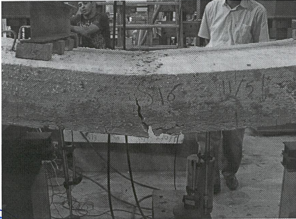
شكل رقم (٢٠) : شكل الاتهيار بعينات المجموعة الرابعة (البلاطه S16).
